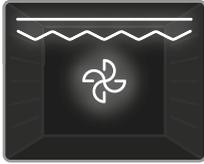
**Doppel-Grill- und Umluft-Funktion:** Das Backofenthermostat und die Warnleuchten werden eingeschaltet, und das
