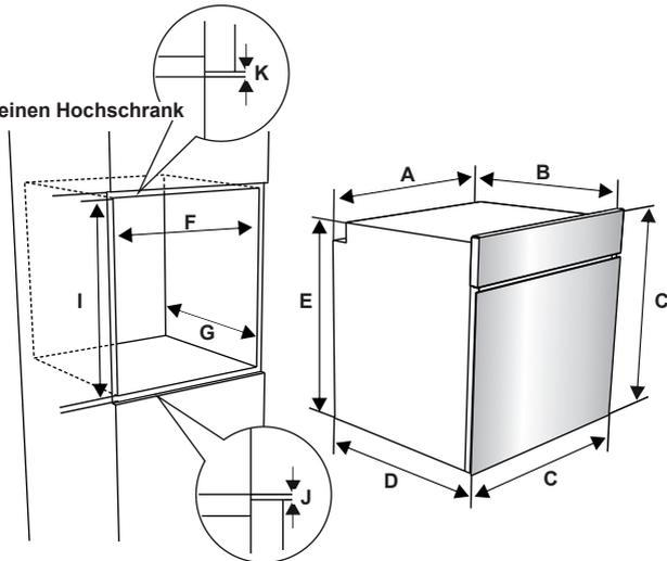
Nachdem alle elektrischen Anschlüsse ausgeführt wurden, den Backofen in den Einbauschränk einschieben. Die Backofentür öffnen, und die 2 Schrauben in die Löcher im Rahmen des Backofens einschrauben. Bei an der Schrankoberfläche anliegendem Geräterahmen die Schrauben festziehen.
