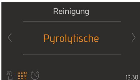
Sie können die Pyrolyse-Reinigung auf drei verschiedene Reinigungszeiten einstellen. Wie folgt gelangen Sie in das Reinigungsmenü.
